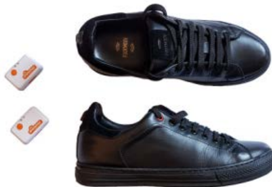
Abbildung 8: Beschleunigungssensoren (links) FooMoov2 Schuhpaar (rechts) (Avvenuti u.a. 2018)
